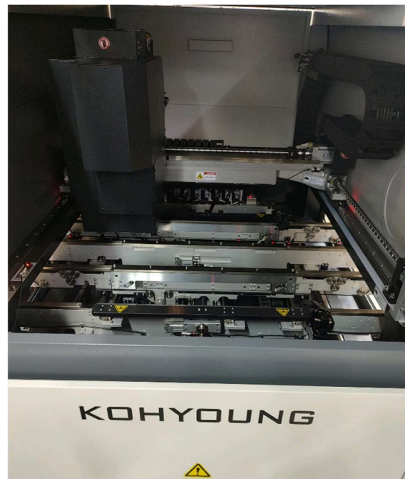
Figura 2 - AOI ZENITH LITE (vista interna)
